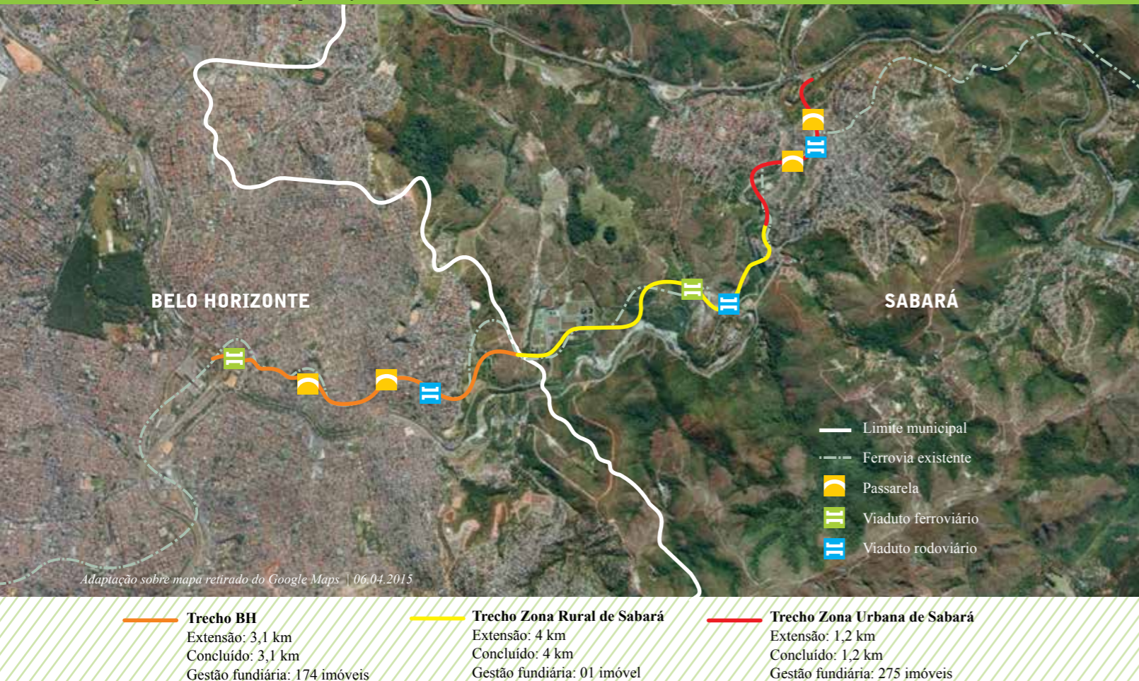
Figura 1 – Intervenções realizadas pelo Projeto Modernização BH-Sabará
