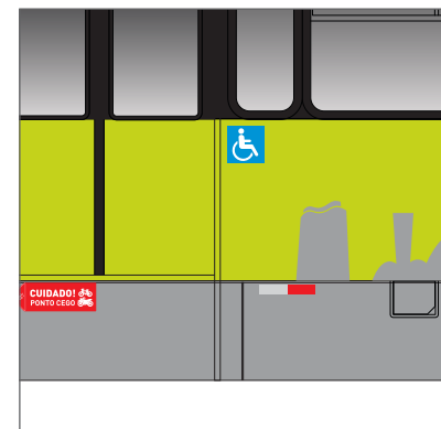
Lateral esquerda: posicionado do lado direito da primeira porta a uma distância de 30 mm desta e do bordo inferior da janela - 200 x 200 mm
