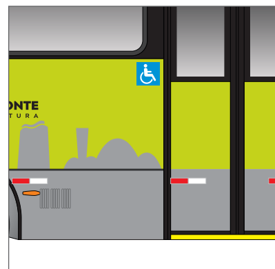
Lateral direita: posicionado do lado esquerdo da segunda porta a uma distância de 30 mm desta e do bordo inferior da janela - 200 x 200 mm
