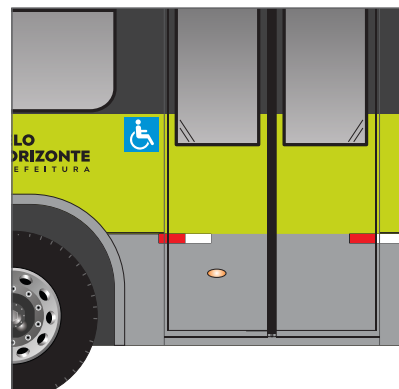
Lateral direita: posicionado do lado esquerdo da segunda porta a uma distância de 30 mm desta e do bordo inferior da janela - 200 x 200 mm
