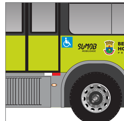
Lateral esquerda: posicionado do lado direito da segunda porta a uma distância de 30 mm desta e do bordo inferior da janela - 200 x 200 mm
