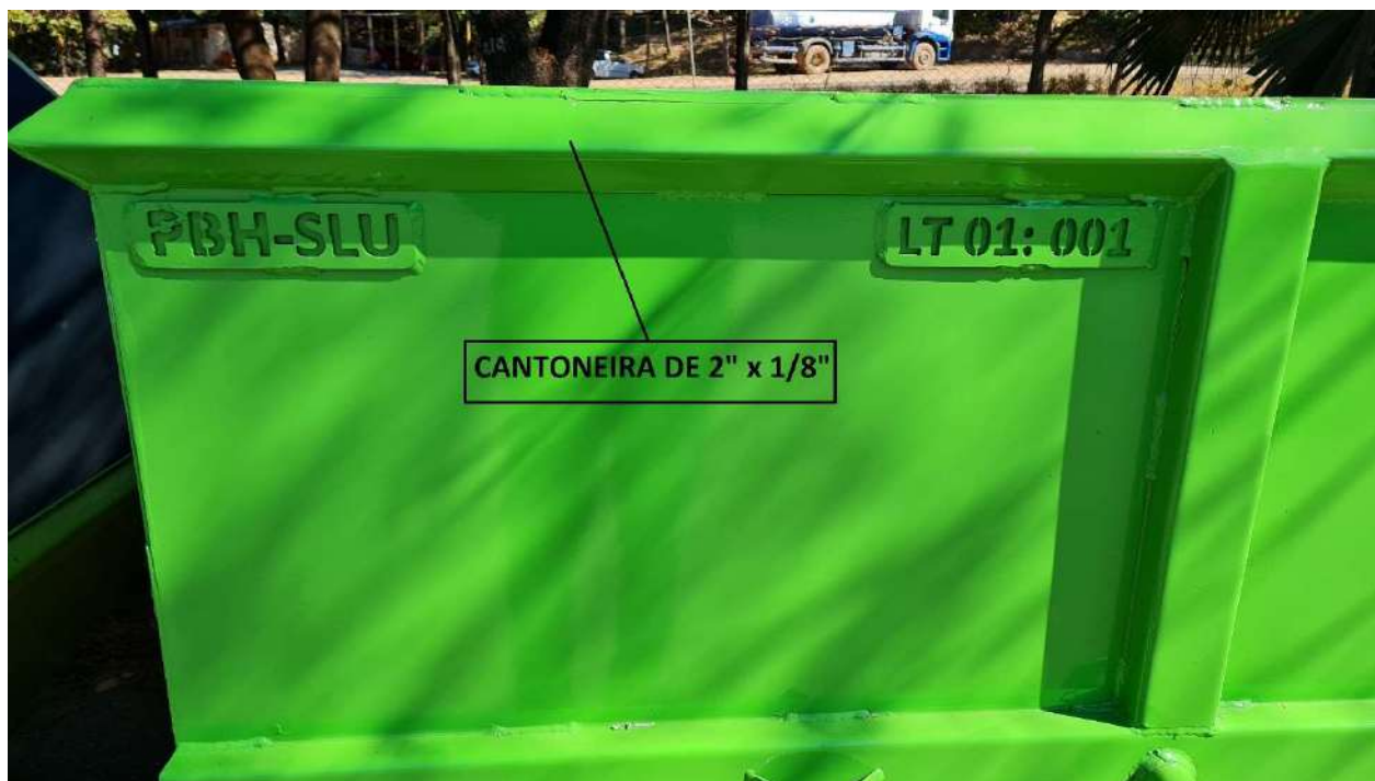
FOTO Nº 04 – cantoneira de 2" x 1/8" utilizada
