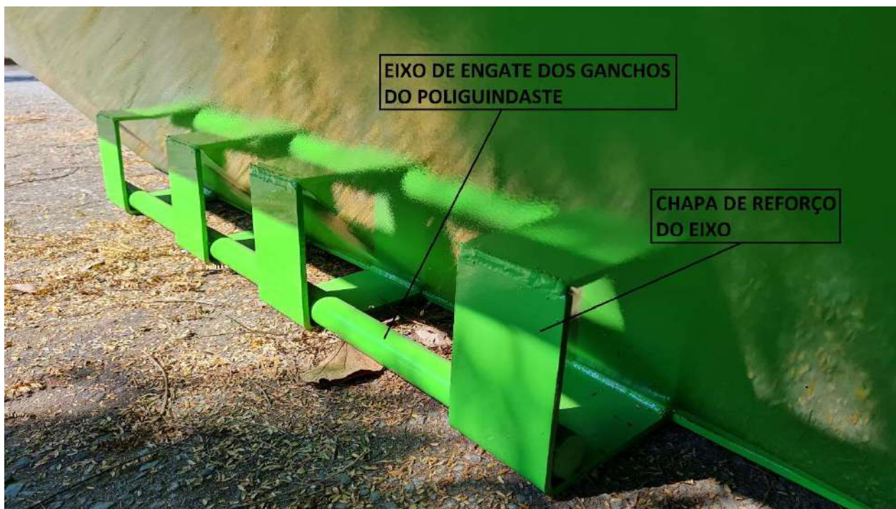
FOTO Nº 06 – eixo de engate \varnothing 1 \frac{1}{4} " ao invés de \varnothing 1 \frac{1}{2} " e chapa de reforço do eixo de \frac{1}{4} " ao invés de \frac{5}{16} "
