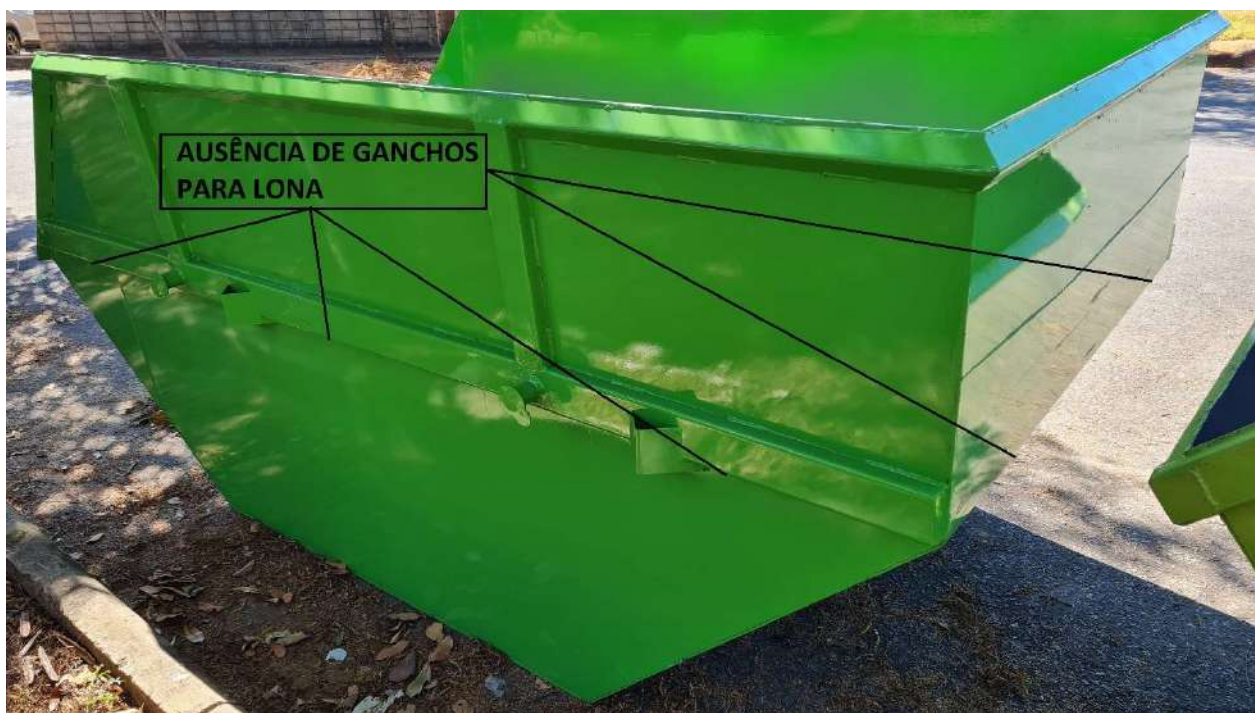
FOTO Nº 07 – faltam ganchos p/ fixação de lona, sendo 2 frontais, 2 traseiros e 3 em cada lateral da caçamba
