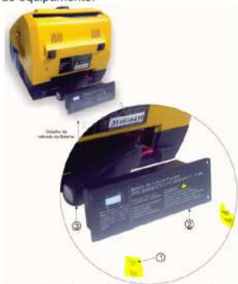
Figura 62 – Substituir o pack de bateria
