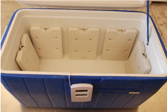
Figura 4: Organização dos gelox dentro da caixa térmica sem berço
