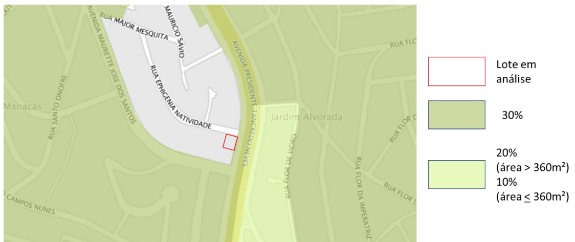
Figura 04: Mapa com taxas de permeabilidade conforme Lei 11.181/19, na região. Fonte: Adaptado de BHMap, 2020
