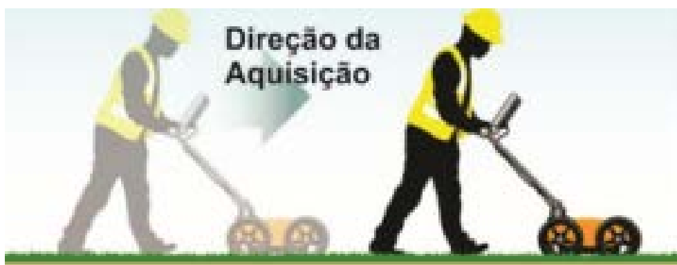
Figura VI.6 - Esquema de aplicação do método GPR. Fonte: Adaptado de Ramos (2022).
