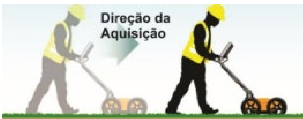
Figura J.6 - Esquema de aplicação do método GPR. Fonte: Adaptado de Ramos (2022).
