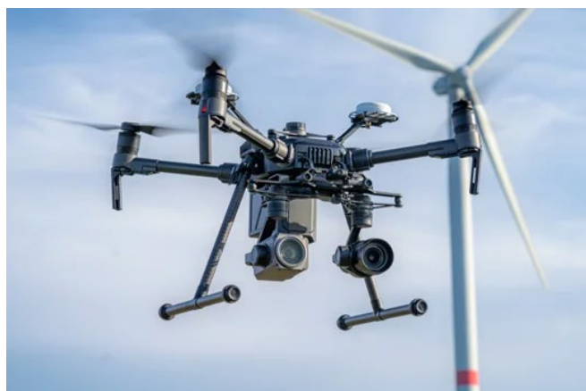
Figura J.2 - Exemplo de drone equipado com câmeras fotográficas embarcadas. Fonte: Cavallieri; Campos (2022).
