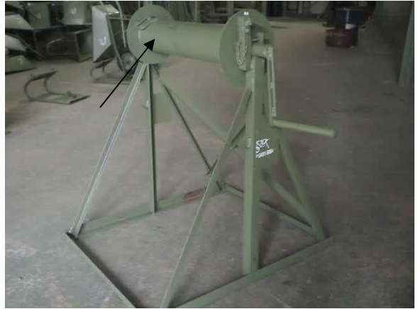
A seta indica a alça soldada no tambor, para amarração do cabo (corda).
