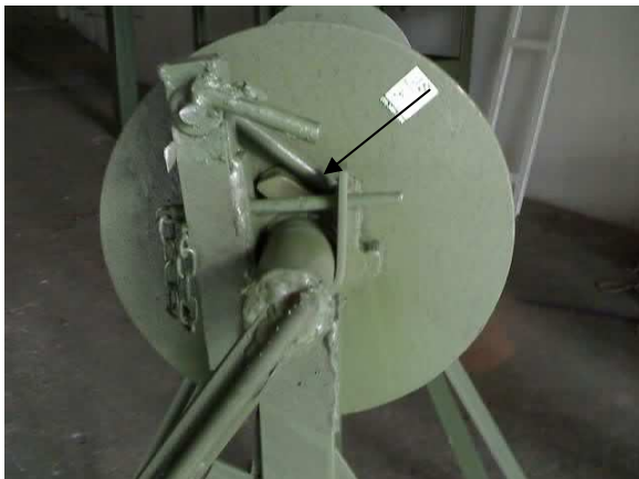
A seta indica a trava do cilindro, impedindo que ele gire em sentido anti-horário.
