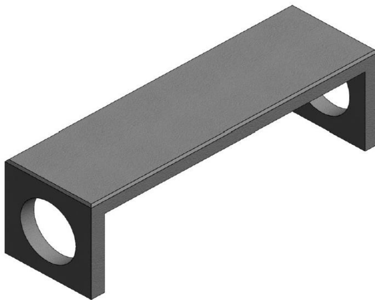
Figura 12 - Imagem 3D do banco de concreto pré-fabricado. Elaboração própria. Nota: Desenho elaborado em 21/07/2025.
