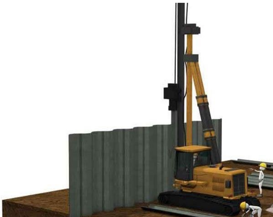
Figura 29 - Detalhe execução de contenção em Estaca Prancha. Fonte: TCPO (2014).
