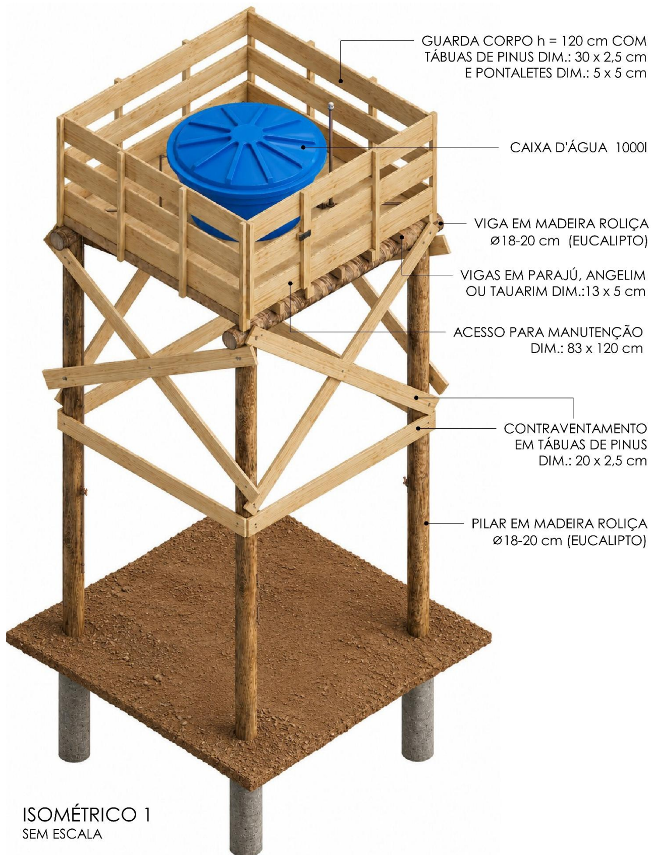
Figura 33 - Modelo 3D dos elementos construtivos da torre de caixa d'água provisória. Elaboração própria. Nota: Desenho elaborado em 03/07/2026.
