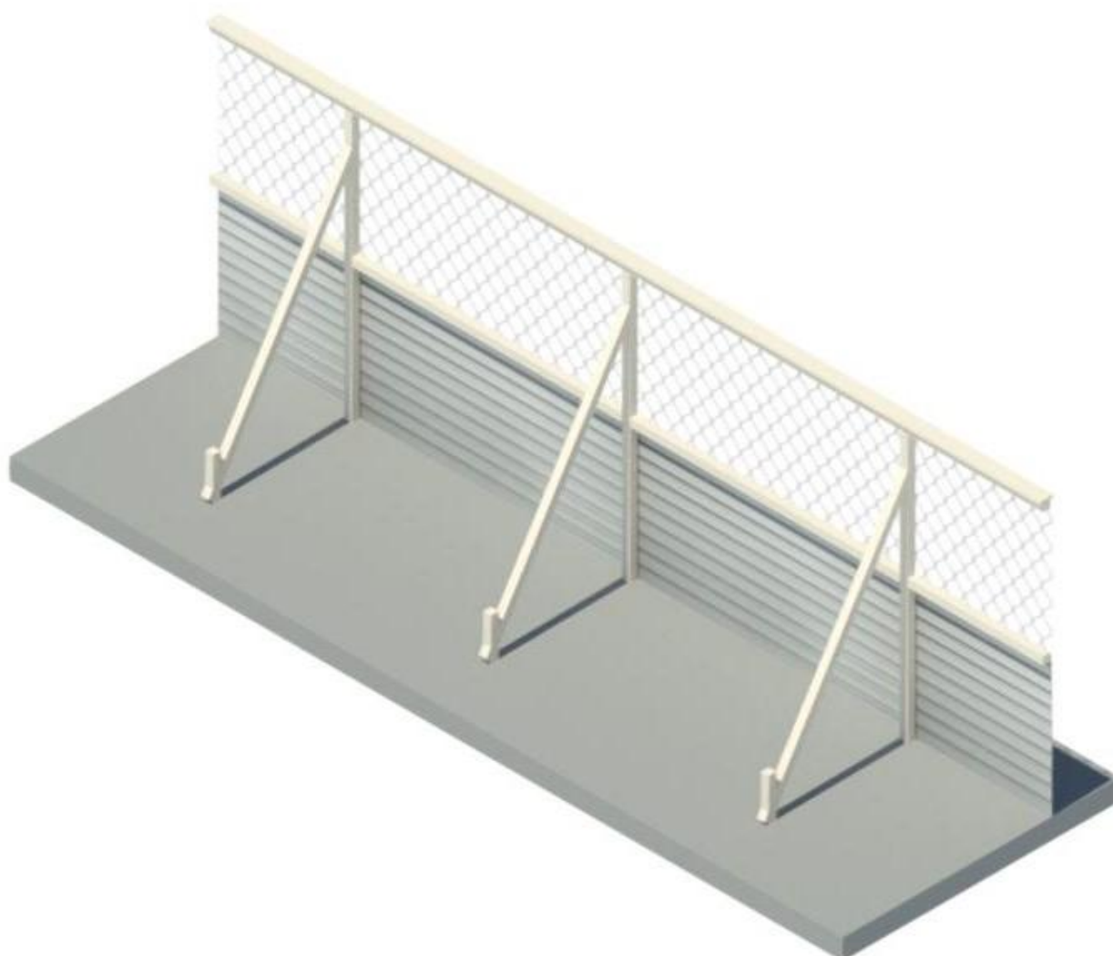
Figura 58 - Imagem 3D do tapume metálico com tela e base enterrada. Fonte: Elaboração própria. Nota: Desenho elaborado em 21/12/2023.
