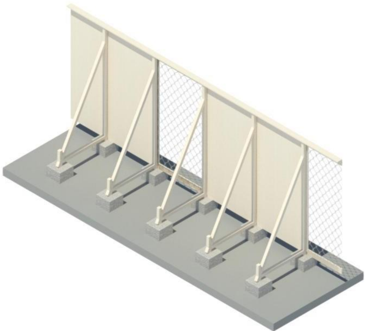
Figura 46 - Imagem 3D do tapume de madeira com base de concreto. Fonte: Elaboração própria. Nota: Desenho elaborado em 21/12/2023.
