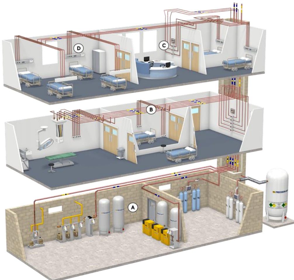
Figura 19.1 - Perspectiva esquemática da instalação de um sistema de gases medicinais em uma unidade de saúde. Legenda: Central de suprimentos (A); Rede de distribuição (B); Sistemas de alarmes e monitoração (C); Postos de distribuição (D). Fonte: Adaptada de Gomes (2021).
