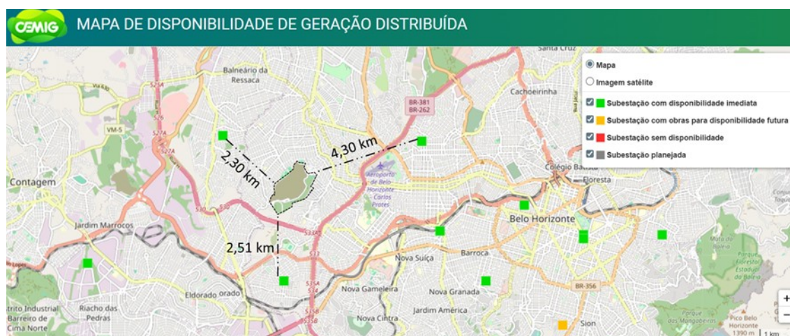
Figura 29 – Localização das subestações em relação ao Parque Aterro
