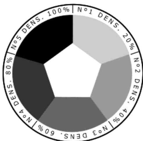
A Escala Ringelmann é um hexágono com faixas de cinza (0 a 100%) utilizado para medir a concentração de poluentes da fumaça. Para a medição o encarregado deve estar a uma distância de 2 a 5 metros do escapamento do veículo ou equipamento e verificar se a fumaça no centro da Escala está acima da faixa 40%, que caracteriza uma situação não-conforme e exige providências.
