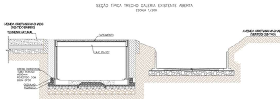
Seção típica da solução em canal complementar paralelo ao existente para o Ribeirão Pampulha
