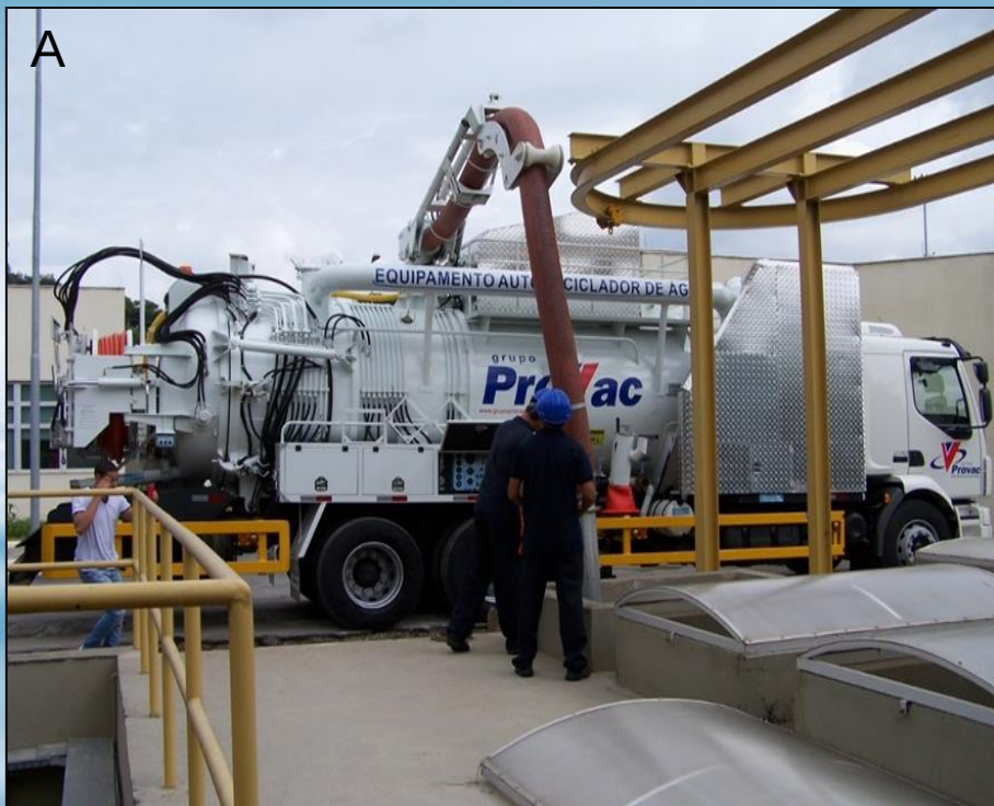
Fotos A e B: Caminhão com equipamento conjugado (Hidrojato e Sucção)
