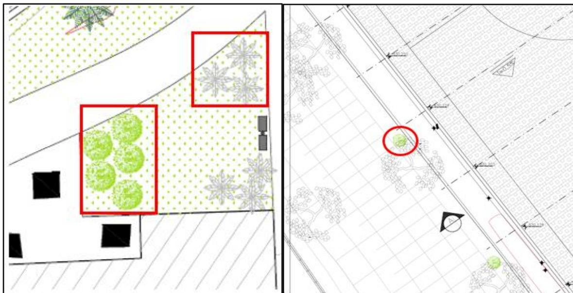
**Figura 1:** Elementos gráficos representados na planta de implantação, aparentando indicar plantio de elemento vegetal não identificado na legenda.
