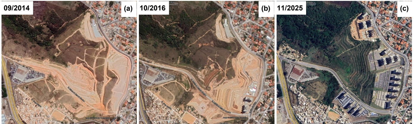
Figura 06: Em “a” a “c” mudança na topografia do local com exposição do solo em a e aterro em b, culminando na situação atual da topografia com os relevos reconformados e com infestação de Leucenas em “c” (Fonte: Google Earth).
