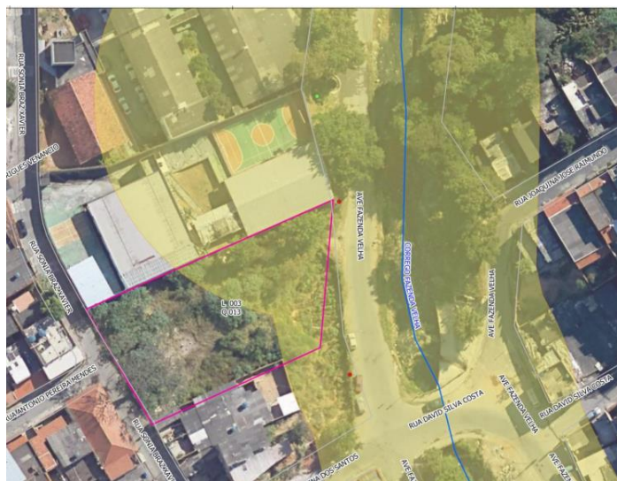
Nova demarcação da APP da nascente situada aos fundos da escola que implicou em ampliação da intervenção, com pequena parcela se localizando em parte da projeção da edificação prevista.
