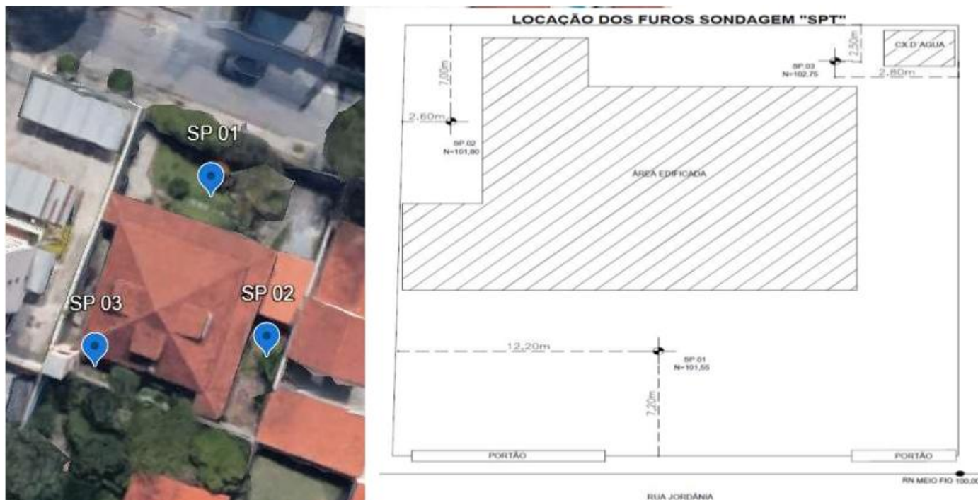
Figura 14: Locação dos furos de sondagens
