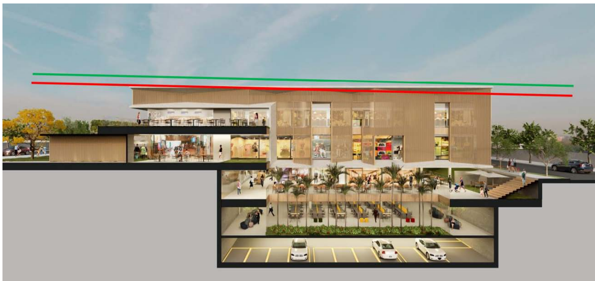
Corte esquemático. Limite de altimetria PBH (em verde). Limite de altimetria DPCA (em vermelho). Fonte: Memorial Descritivo.
