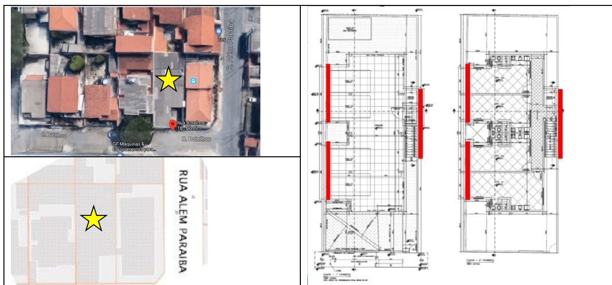
Fig. 01: Conjunto de imagens que ilustram o contato da nova edificação com as divisas laterais.
