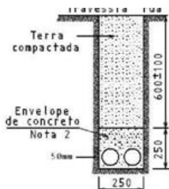
Figura 3 - Detalhe da tubulação subterrânea em ruas e avenidas
