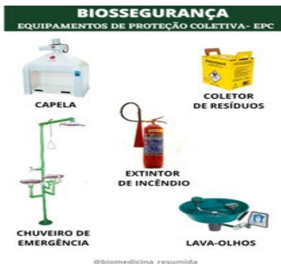
Figura 4 - Equipamentos de proteção coletiva.
